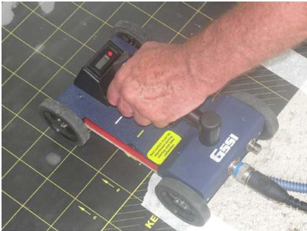
Foto 4. Ensaio com radar sobre a laje da estrutura.
