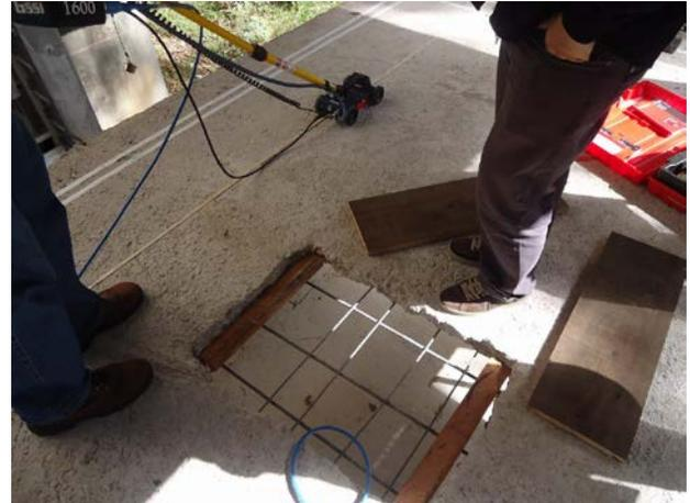
Foto 5. Vergalhões de mesmo diâmetro situados a mesma profundidade existentes na laje da estrutura de concreto que foram identificados com o radar.
